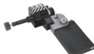
Automatische Schleifvorrichtung für Innen- und Stirnflächen
